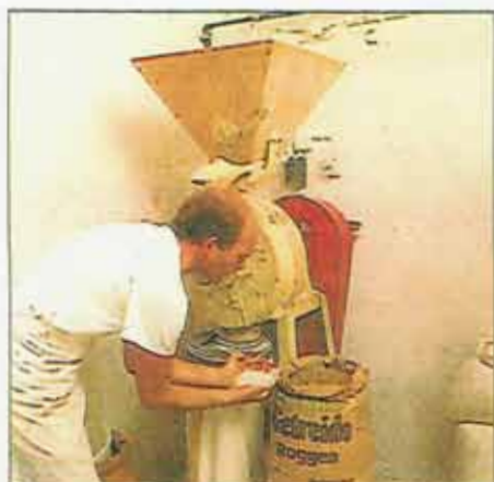
Auf hauseigenen Steinmühlen wird das gereinigte Getreide kurz vor der Teigbereitung schonend vermahlen.
